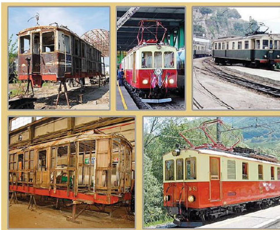
I cambiamenti che hanno portato al restauro dell' locomotore B51 della tratta Ora-Predazzo
