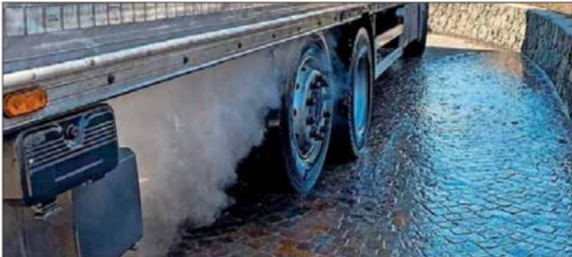
Die Bremsbacken gerieten in Brand (im Bild).
